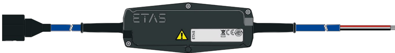
図 1: RB150 プラグ付きラムダセンサ入力およびオープンケーブル端付きアナログ出力
