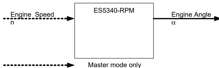
Abb. 23-4 Steuer- und Statussignale der Drehzahleinheit bei der Simulation von Verbrennungsmotoren
