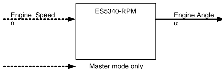
Abb. 22-4 Steuer- und Statussignale der Drehzahleinheit bei der Simulation von Verbrennungsmotoren
