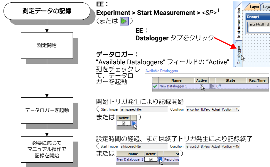
図 4-36 測定データを記録する
