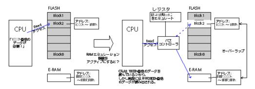
通常時においては、ECUの制御プログラムはフラッシュメモリ上のパラメータを読み込んで動作します。しかしエミュレーションRAM機能を有効にすると、内蔵RAMの特定の領域がエミュレーションRAMとして使用され、この領域がフラッシュメモリの一部をブロック単位でエミュレートします。エミュレーションRAMの有効化/無効化は、ECU内の制御レジスタによって制御されます。
