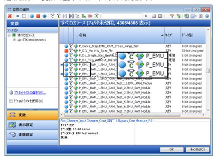
上図の例のとおり、エミュレートされていない(つまり適合を行えない)適合変数について は、変数のシンボルの左側にオレンジの矢印が表示されます。適合可能な適合変数に は緑色の矢印が表示されます。
