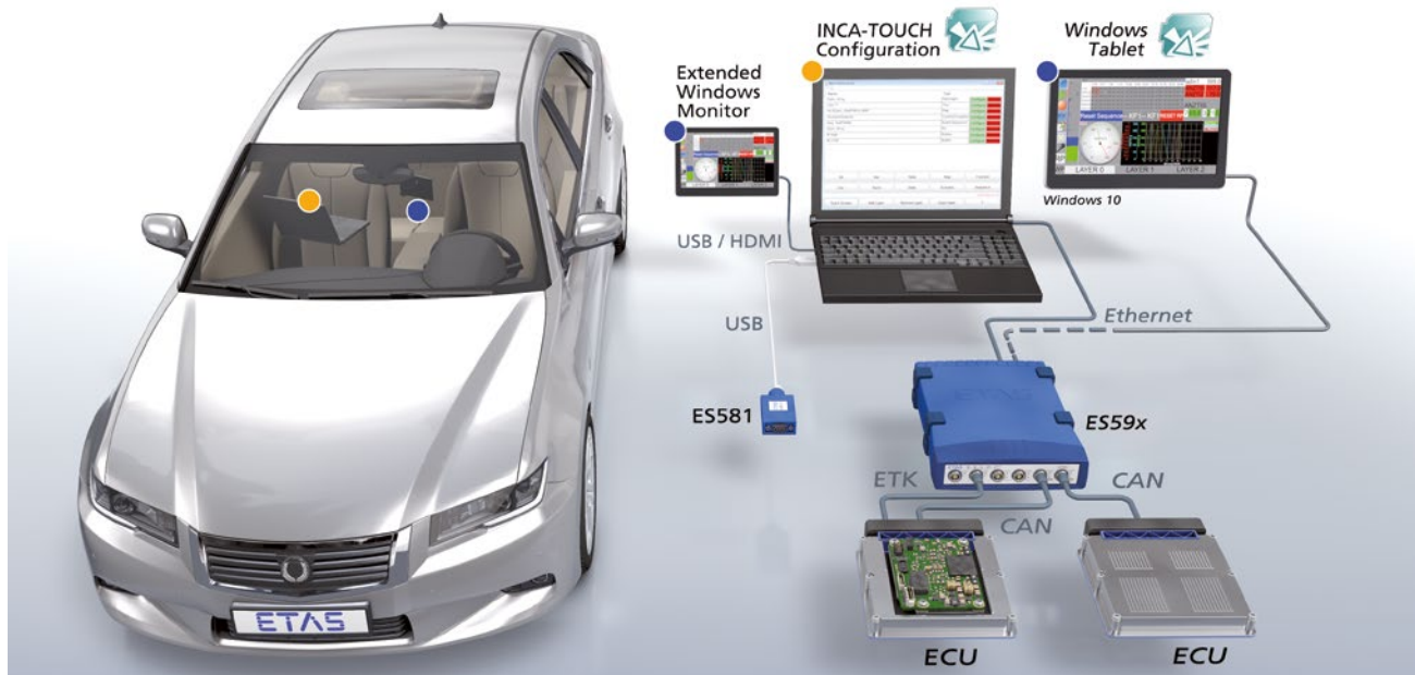
Abbildung 2: Verwendung von INCA-TOUCH mit einem Touchscreen oder Windows-Tablet. Blaue Punkte: Positionen des Touchscreens oder Windows-Tablets im Fahrzeug. Gelber Punkt: Position des Laptops (optional).
