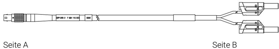
**Abb. 8-2** Kabel CBP1205-2 (Stromversorgungskabel mit Sicherheits-Bananenstecker)
