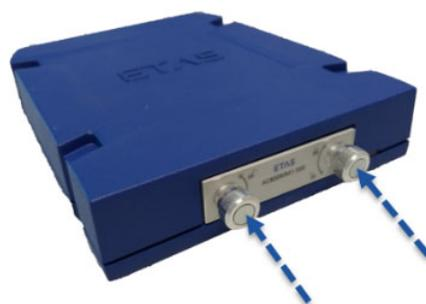
**Abb. 4-2** Druck-Drehverschlüsse eindröcken
