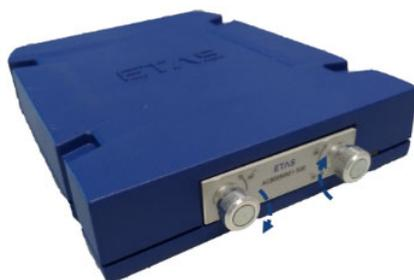
**Abb. 4-3** Druck-Drehverschlüsse drehen
