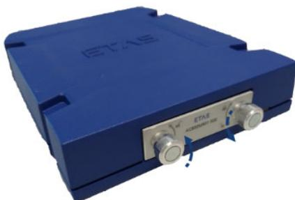
**Abb. 4-4** Druck-Drehverschlüsse eindrücken und drehen
