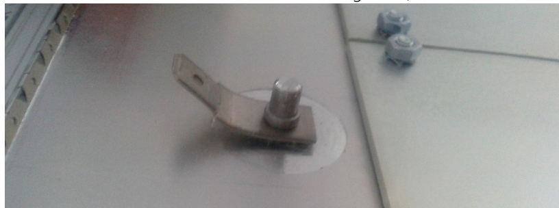
Abb. 3-3 PE-Kontakt an der Innenseite der Fronttür des ES5300.1-A Housings.
