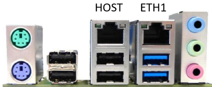
Abb. 2-11 Die LAN-Anschlüsse „ETH1“ und „HOST“ der FUJITSU® D3348-B-Hauptplatine
