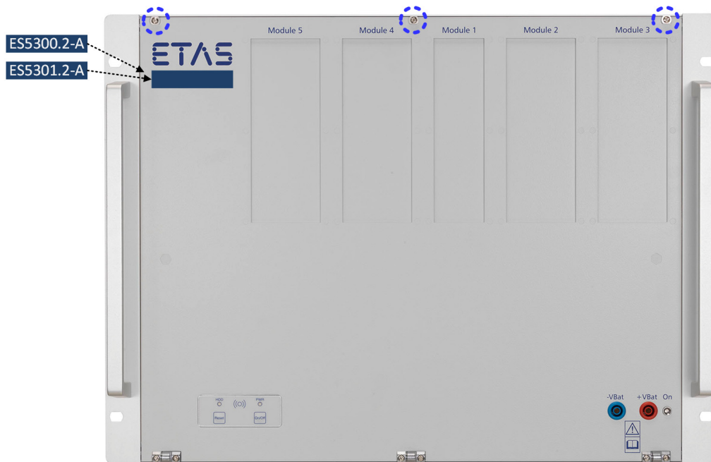
Abb. 2-2 Die Frontplatte des ES5300.2-A Housings / ES5301.2-A Housings Die Frontplatte kann nach Öffnen der drei Schrauben am oberen Rand aufgeklappt werden (siehe Seite 58).
