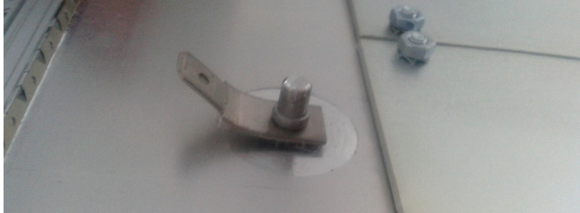
Abb. 3-3 PE-Kontakt an der Innenseite der Fronttür des ES5300.2-A Housings / ES5301.2-A Housings.
