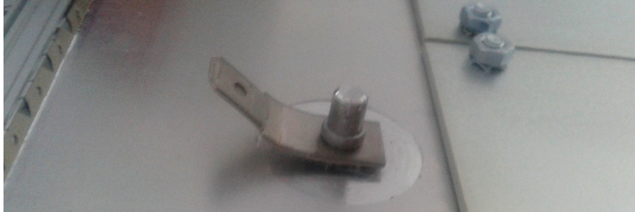
Abb. 3-3 PE-Kontakt an der Innenseite der Fronttür des ES5300.1-A Housings und des ES5300.1-B Housings
