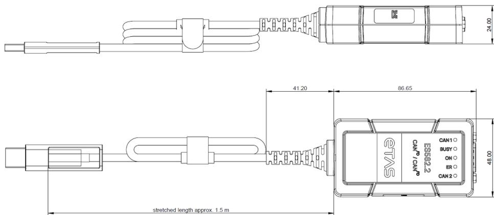
**Fig. 5-2** Abmessungen
