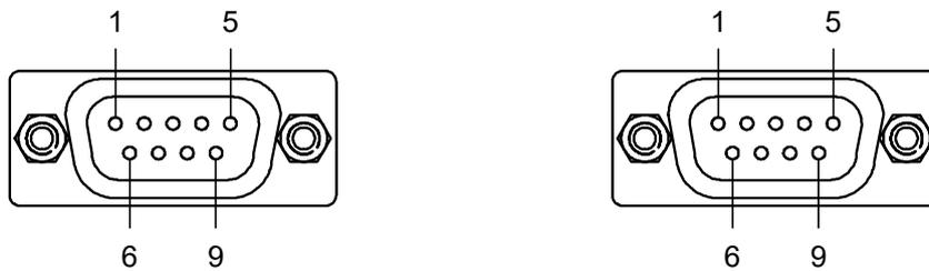
**Fig. 6-2** Kabel CBCF100: DSUB-Anschluss "1" und "2"
