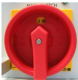
Pääkytkin (MAIN SWITCH)
