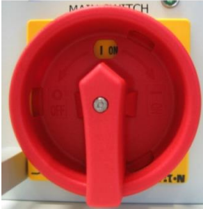
Interrupteur principal (MAIN SWITCH)
