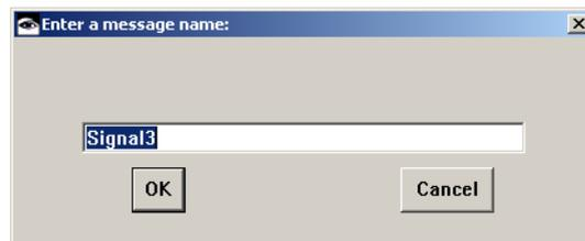
In das Dialogfenster wird der neue Message-Name eingegeben, unter dem die Message als globale Send&Receive-Message im Projekt eingetragen wird.
