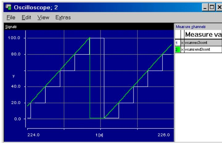
Die Send-Message `vcansend3cont` wird im 10 ms-Raster gerechnet (Prozess `calcCANLoop` in der Task `T10ms`), deswegen verläuft die grüne Kurve ebenso glatt wie die Kurve von `vcansend2cont`. Der Wert wird im 200 ms-Raster gesendet (Prozess `CanioMSG101_T200ms_HWCL` in der Task `T200ms`) und im Interruptbetrieb, getriggert durch die Task `Analyse` über die Receive-Message wieder empfangen. Entsprechend stufig verläuft die Kurve für `vcanrec3cont`.
