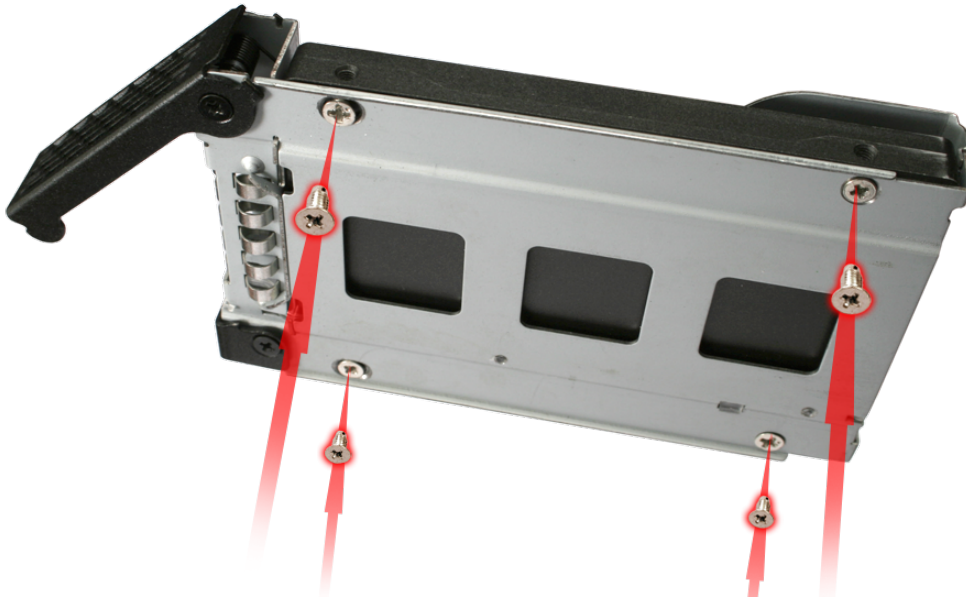
Abbildung 05.2: Montage eines Laufwerks im Einschub
