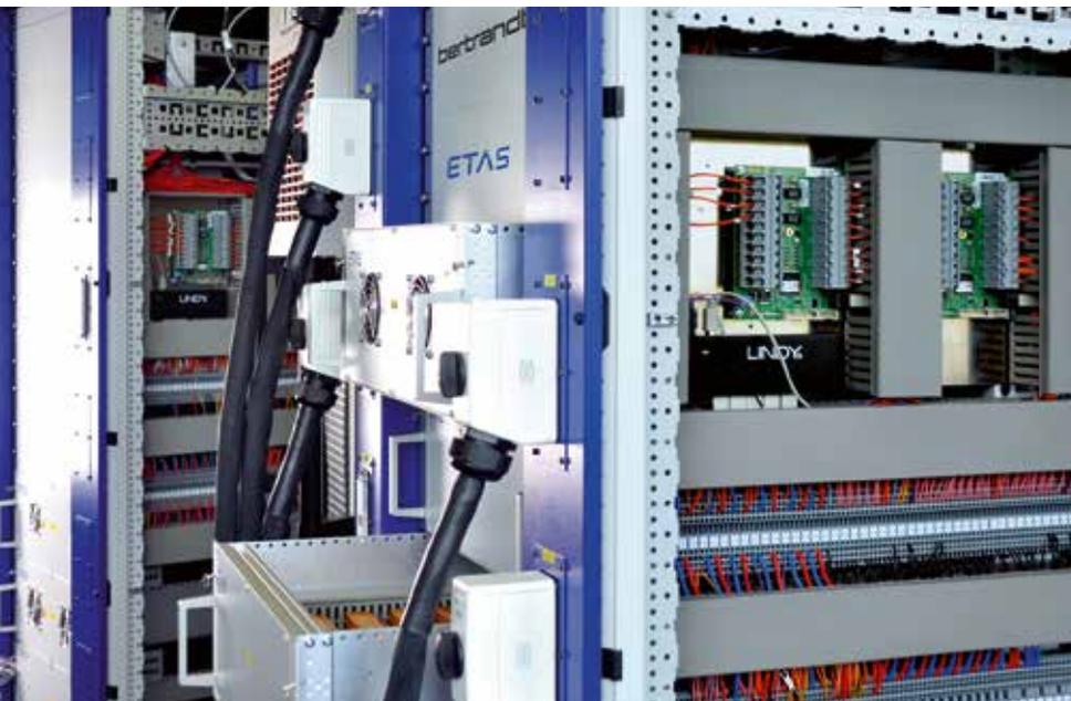
**Der Bertrandt-Konzern bietet Automobilherstellern Rundum-Tests der kompletten Fahrzeugelektronik von der Testspezifikation bis zur Freigabe an. Zu diesem Zweck hat Bertrandt ein neues Testhaus mit leistungsfähigen HiL-Prüfständen aufgebaut. Dort können E/E-Tests vollautomatisch, modular und skalierbar mit großer Breite und Tiefe effizient durchgeführt werden.**
