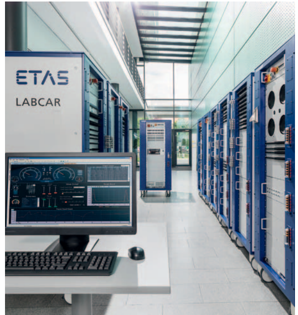
Bild 2: HiL-Prüfstände lassen sich auf der Basis der Network-Labcar-Technologie von Etas zu umfangreichen Gesamtsystemen koppeln.
