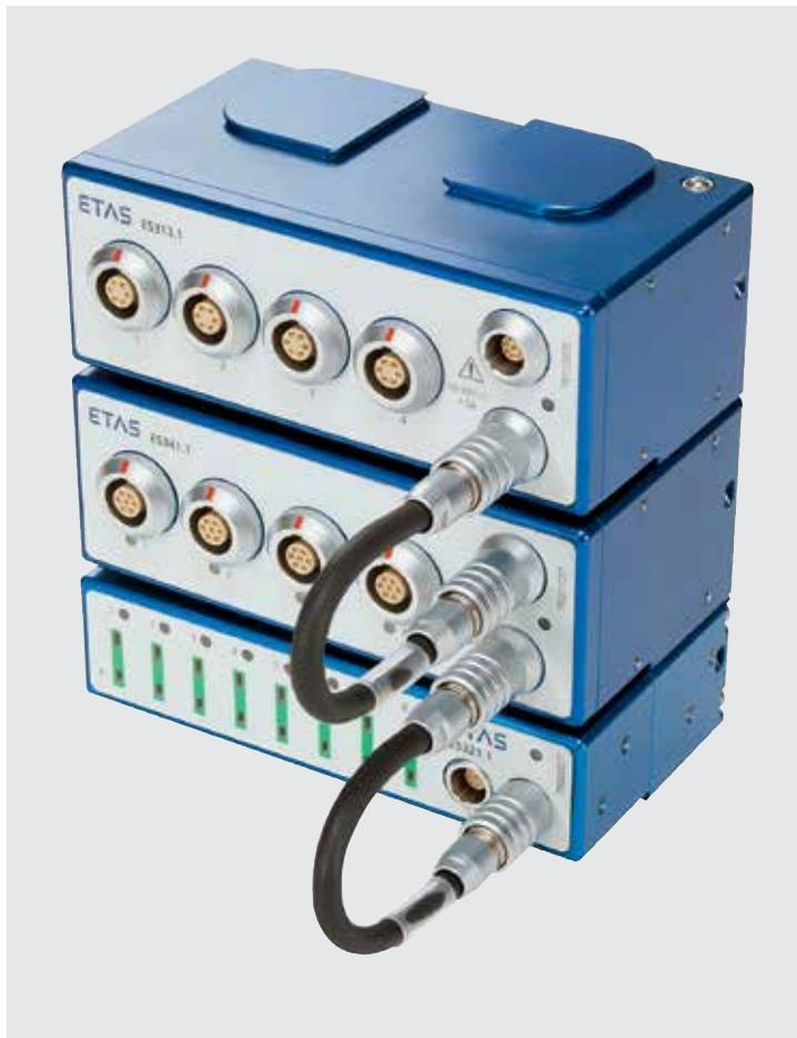
CONNECTING THE MEASUREMENT MODULES OF THE ETAS ES300 FAMILY WITH EACH OTHER IS EASY.
