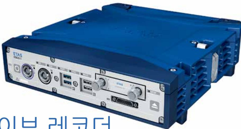
이타스 ES800 시스템의 새로운 ES820 드라이브 레코더 모듈은 INCA PC 또는 노트북을 대체합니다. 이 모듈은 개발 및 캘리브레이션, 차량 전자 시스템의 검증을 위한 다양한 측정 작업에 사용할 수 있습니다. 또한 ES89x 및 ES5xx 인터페이스 모듈과 함께 ETK, XETK 또는 고
