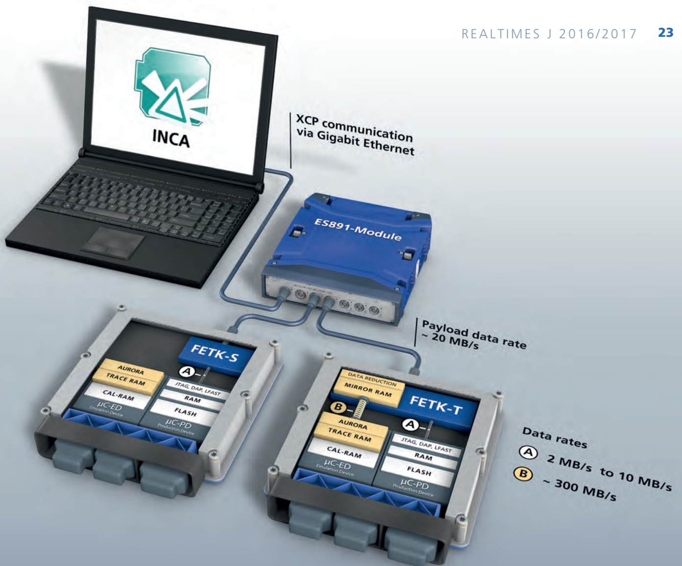
図 2: ECU から FETK インターフェイス経由でデータを取得。FETK には FETK-S (左) と FETK-T (右) の 2 つのバージョンがあり、どちらのバージョンも、制御アクセスには JTAG (Joint Test Action Group)、DAP、または LFAST などといったマイクロコントローラ固有プロダクションデバイス (μC-PD) デバッグインターフェイスを使用します。さらに、FETK-T バージョンは、特に高性能マイクロコントローラエミュレーションデバイス (μC-ED) トレースインターフェイスを、シリアル Aurora インターフェイスによる ECU からの高性能トレースデータ転送と一緒にサポートしています。
