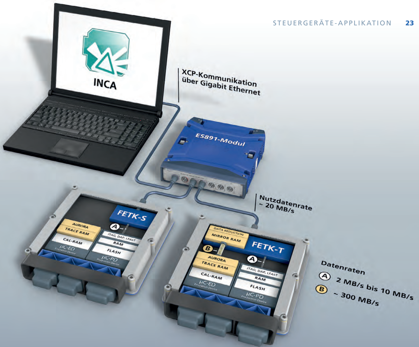
Bild 2: Erfassung von Daten aus dem Steuergerät über die FETK-Schnittstelle. FETKs werden in den beiden Ausführungen FETK-S (links) und FETK-T (rechts) angeboten. Beide Varianten nutzen eine mikrocontrollerspezifische Debug-Schnittstelle der Production Devices ( \mu\text{C-PD} ) wie JTAG (Joint Test Action Group), DAP oder LFAST als Zugang zur Steuerung. FETKs vom Typ T unterstützen zusätzlich dazu die besonders leistungsfähigen \mu\text{C} -Trace-Schnittstellen der Emulation Devices ( \mu\text{C-ED} ) zusammen mit der performanten Übertragung von Trace-Daten aus dem Steuergerät über das serielle Aurora-Interface.
