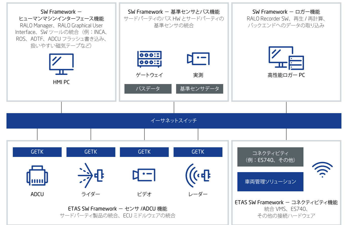
図 5：ETAS の計測データ収集模式図
