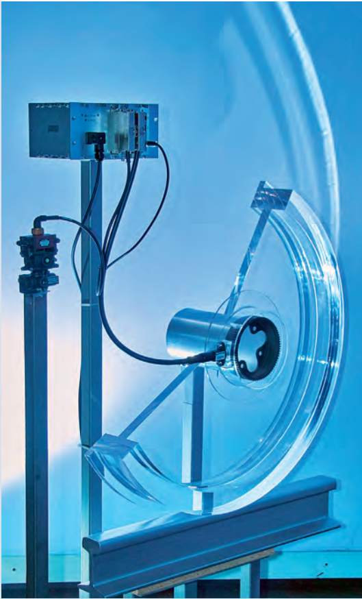
車輪レールシステム： ブレーキシステムの横滑り防止／スリップ防止装置がブレーキング によるフラットスポットの発生を防止
