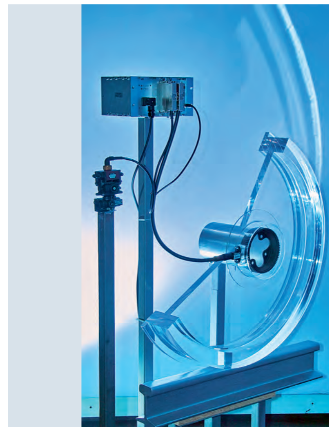
Rad-Schiene-System: Der Gleitschutz des Bremssystems verhindert das Einbremsen von Flachstellen.
