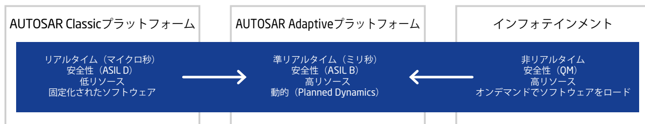
図 1 : AUTOSAR Classic とインフォテインメント / IT アプリケーションの連係に重要な AUTOSAR Adaptive プラットフォーム
